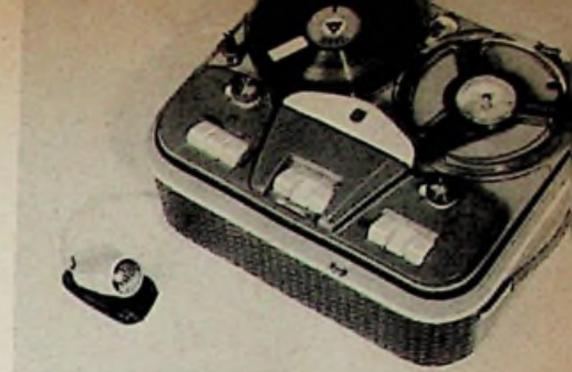
Bild 1. Das Tonbandgerät RK 40 mit dem dynamischen Mikrofon EL 6112
