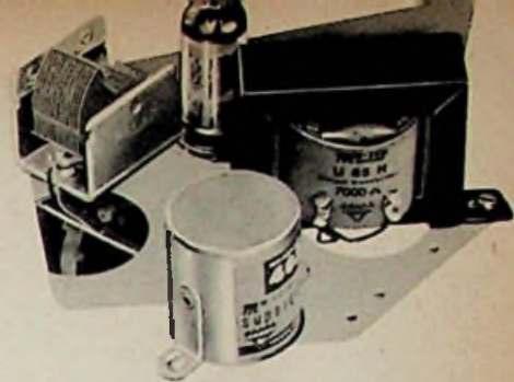
Die wichtigsten Einzelteile des Einkreislers UN 48
