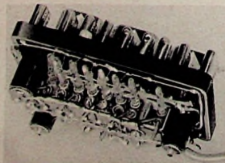
Bild 2. Eine Reihe von Thermo-Gasdruckrelais zum Umschalten von Quarzen im Funksprechgerät Teletype V
