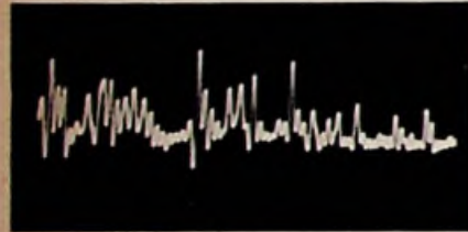
Bild 3b. Ausgefilterte Wackelkontakt - Störspannung nach Bild 3a
