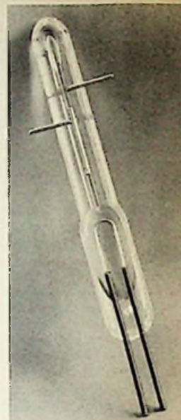
Bild 1. Thermo-Gasdruckrelais von Telefunken. Unten ist der Heizfaden zu erkennen; beim Durchschicken eines Stromes erwärmt er das ihm umgebende Stickstoffgas. Es dehnt sich aus und treibt den Quecksilberfaden hoch, so daß dieser die beiden seitlich eingeschmolzenen Kontakte verbindet
