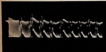
Bild 3a. Oszillogramm einer durch Kontaktfehler modulierten Prüffrequenz
